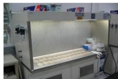
Per flusso d'aria laminare si intende un flusso d'aria che si muove a velocità uniforme lungo linee parallele con il minimo di turbolenza.
