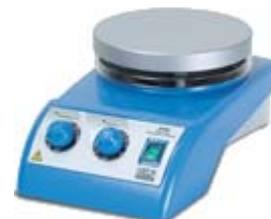
Gli agitatori magnetici spesso sono anche dotati di riscaldamento per mezzo di una resistenza elettrica posta sotto il piano d'appoggio. Le temperature che possono essere raggiunte variano da poche decine di gradi fino a 300 °C a seconda della qualità professionale dello strumento.
