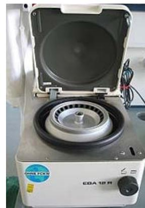
A quanto sopra detto si deduce che basta far ruotare velocemente attorno ad un asse un recipiente apposito per ottenere una stratificazione, solido nel punto più lontano dall'asse, liquido verso l'interno. Salvo casi speciali, lo scopo della centrifugazione è però la separazione, totale o quasi, tra solido e liquido: esiste quindi la necessità di estrarre separatamente la fase solida dalla fase liquida. Una classificazione può quindi essere stilata in base al tipo di funzionamento:
