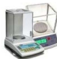
Inoltre, l'oggetto della misura deve trovarsi a temperatura ambiente, affinché non sussistano correnti convettive interne al recipiente, che possano dare una misura errata. Una precisione simile viene raggiunta mantenendo costante il carico sul bilanciante e sottraendo masse dallo stesso lato del peso incognito, invece che aumentarle.
